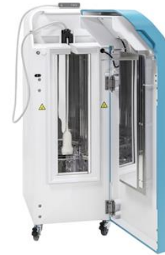
Figure 4 : Système de désinfection de haut niveau Chronos développé par Germitec
